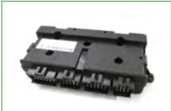
CAN-Bus Knoten mit Klimaregelsoftware
