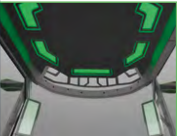
<< Leuchtextil für Ambientelicht und optische Meldung der Ultraschall Sensoren
