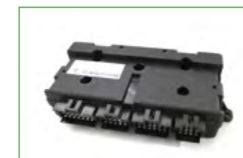
CAN-Bus Knoten mit Klimaregelsoftware
